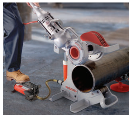
Труборез модели 258 с силовым приводом № 700 в процессе использования для резки
